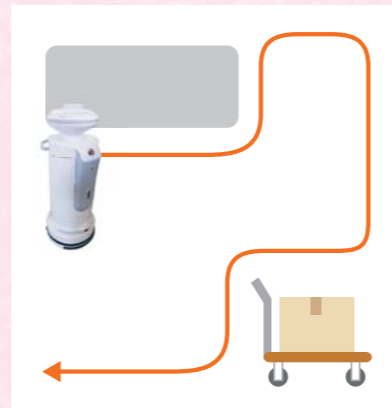
走行ルートに障害物がある場合は障害物を避けて走行します。
