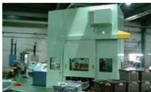
プレス防音カバーの設置（三重工場）
