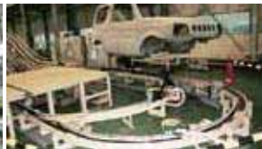
コンベア・システム
